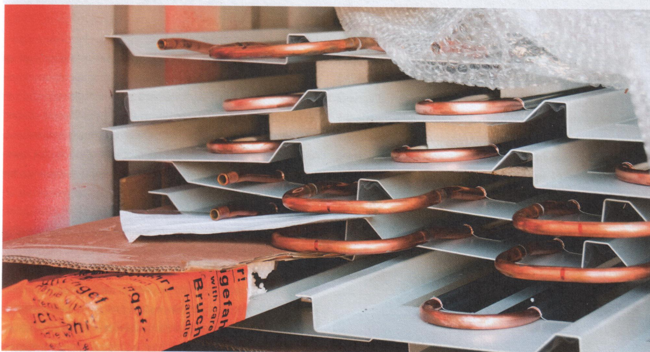
Het koperen leidingbuissysteem is geïntegreerd in het prefab gevelpaneel. (Foto: TNO)
